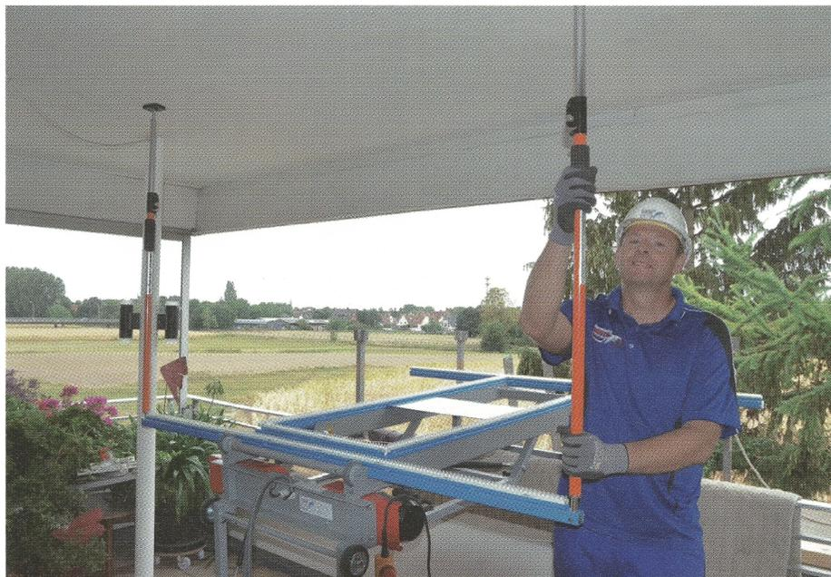
Mit einer zusätzlichen Schiene sowie zwei in der Länge verstellbare Stützen lässt sich der Lift am Gebäude für einen sicheren Stand „verankern“.
